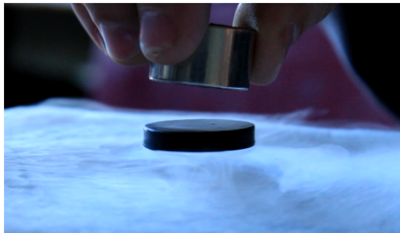
Фото Висящего под магнитом доменного сверхпроводника
