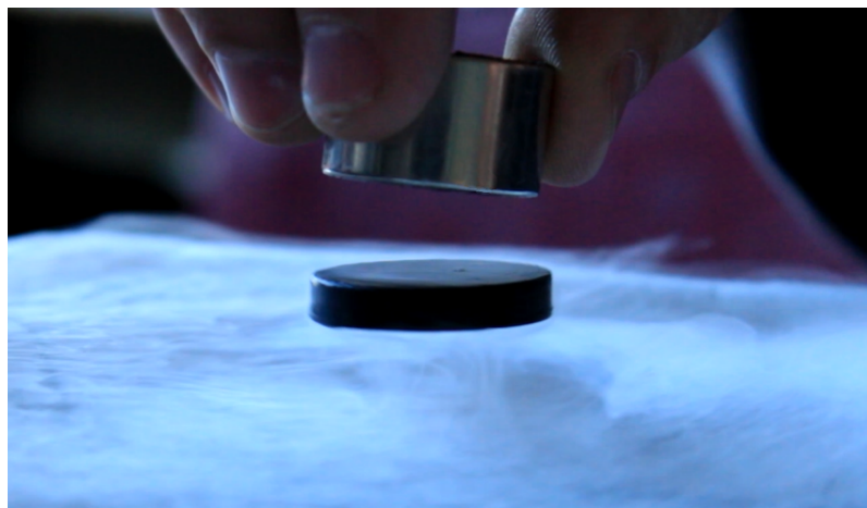
Фото Висящего под магнитом доменного сверхпроводника
